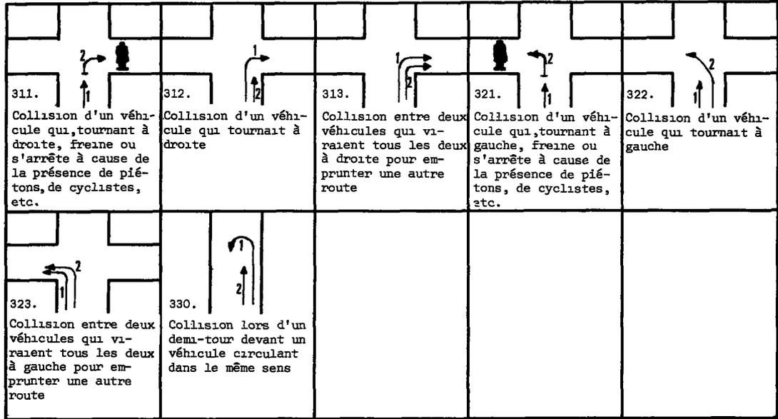
4. Collision entre véhicules circulant dans des sens opposés sur la même route et virant à une jonction en T ou Y, à un carrefour ou pour quitter la chaussée pour entrer dans une propriété
